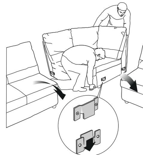
Приподнять модуль оборудованный верхним фиксатором и вставить язычки фиксаторов в ответную часть нижних фиксаторов соседнего элемента
