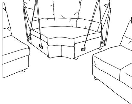
Соединение модулей осуществляется посредством двух металлических фиксаторов, установленных на боковине модуля. В зависимости от способа крепления к боковине, они подразделяются на верхние и нижние.
